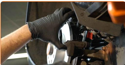
**23** Befestigen Sie die Bremssattelhalterung. Benutzen Sie den XZN #14. Verwenden Sie einen Drehmomentschlüssel. Ziehen Sie ihn mit 90 Nm Drehmoment fest.+90°
