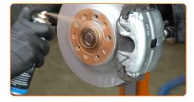
Die Bremsscheibenoberfläche reinigen. Benutzen Sie einen Bremsenreiniger.
