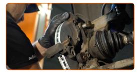
Befestigen Sie die Bremssattelhalterung. Verwenden Sie Stecknuss Nr. 21. Verwenden Sie einen Drehmomentschlüssel. Ziehen Sie ihn mit 190 Nm Drehmoment fest.
