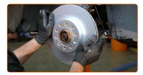
Ziehen Sie die Befestigung der Bremsscheibe fest. Verwenden Sie den Torx T30. Verwenden Sie einen Drehmomentschlüssel. Ziehen Sie ihn mit 4 Nm Drehmoment fest.
