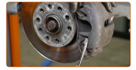
11 Entfernen Sie den Bremssattel.
