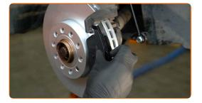
Installieren Sie den Bremssattel und fixieren Sie diesen. Verwenden Sie Inbusschlüssel Nr. H7. Verwenden Sie einen Drehmomentschlüssel. Ziehen Sie ihn mit 30 Nm Drehmoment fest.
