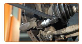
15 Entfernen Sie die Sattelhalterung.
