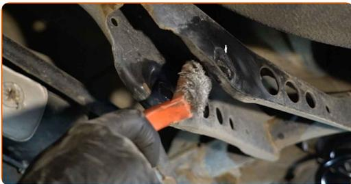
**20** Stützen Sie den Arm. Benutzen Sie einen hydraulischen Getriebeheber. Benutzen Sie ein Brecheisen.
