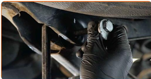
**13** Entfernen Sie den Träger unter dem Arm. Benutzen Sie ein Brecheisen.
