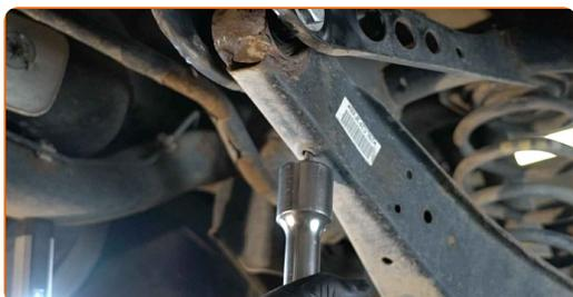
**12** Entfernen Sie die Befestigungsschraube. Verwenden Sie Ring-Gabelschlüssel Nr. 18. Benutzen Sie ein Brecheisen.
