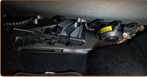
4 Heben Sie die Abdeckung des Innenraumfilter-Gehäuses leicht an.
