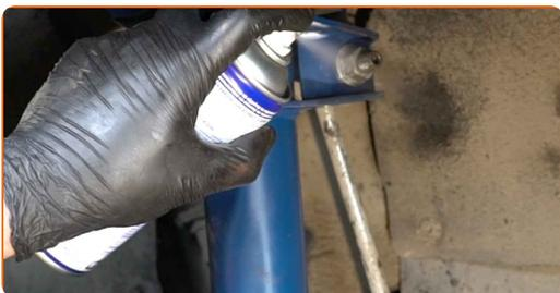
**7** Schrauben Sie das Befestigungselement heraus, das die Druckstange mit dem Federbein verbindet. Verwenden Sie Stecknuss Nr. 18. Verwenden Sie einen Ratschenschlüssel.
