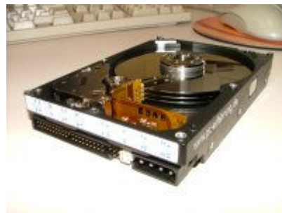
So sieht das Innenleben einer Festplatte aus: Hier deutlich zu sehen Schreib-/Leseköpfe und die Magnetscheiben.
