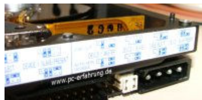
Die Jumper müssen bei IDE-Festplatten richtig gesetzt sein
