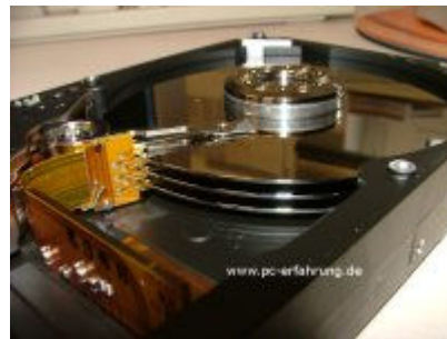
Hier der Schreib-Lesekopf in der Nahaufnahme. Bei mehreren Magnetscheiben hat dieser die Form eines Kammes.
