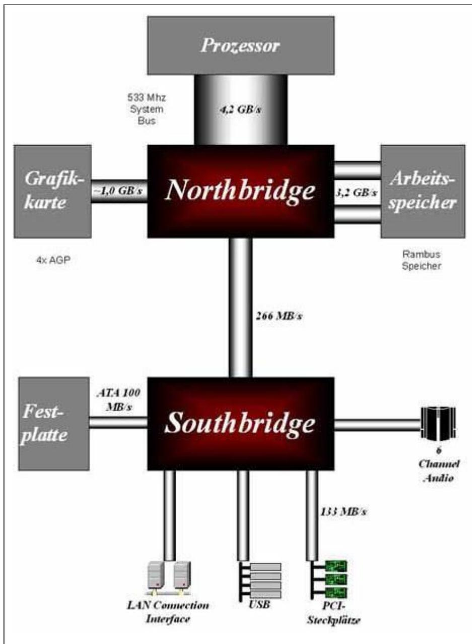
Der Motherboard-Chipsatz besteht aus der North- und der Southbridge. Bei einigen Motherboards mit dem Chipsatz 735 von SiS sind beide Brücken in einem einzigen Chip vereint. Diese basieren auf der Single-Chip-Technologie.
