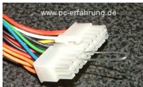
**Starten des Netzteils ohne Einbau in den PC**
