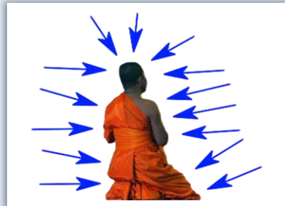
Abbildung 5: Da der Mönch und seine Umgebungsluft ruhen, wirkt auf ihn nur der statische Druck
