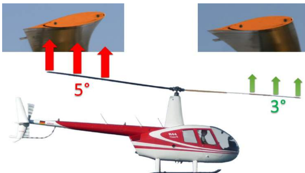
Abbildung 16: Einstellwinkel je nach Blattposition
