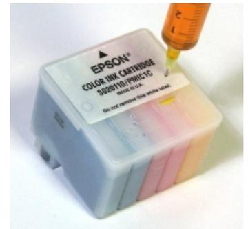
Drücken Sie die Tinte mit der Spritze **ganz langsam** in die jeweilige Farbkammer. Der Schwamm in der Patrone saugt die Tinte sofort auf. Versuchen Sie niemals, mehr Tinte als hier angegeben nachzufüllen. Über die neuen Einstichlöcher können Sie anschließend einen Streifen Klebeband kleben. **Achtung:** die sichtbaren Belüftungslöcher und Luftkanäle der Patrone dürfen dabei nicht mit abgeklebt werden! Lassen Sie die Patrone ca. 1 – 2 Stunden stehen, damit sich die Tinten unten sammeln können.
