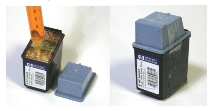
Schneiden Sie vorsichtig mit einem scharfen Messer (Cutter) oder einer kleinen Säge den Deckel von der Patrone runter. Empfehlenswert ist die Verwendung unsers "Patronenöffners" für diese Patronenserien. Der Deckel ist an den Kanten des schwarzen Patronengehäuses aufgeklebt.
