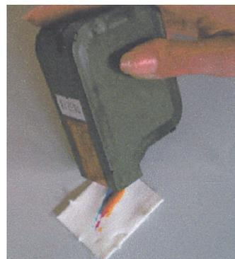
Starten Sie nach dem Einsetzen in den Drucker auch das Düsenreinigungsprogramm.
