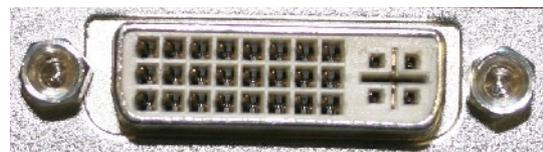
Was die meisten nicht wissen: Es handelt sich typischerweise um DVI-I Schnittstellen, d.h. neben den digitalen Videosignalen werden auch analoge Signale übertragen. Somit ist es möglich mittels eines einfachen Adapters aus einer DVI- eine VGA-Schnittstelle zu machen.
