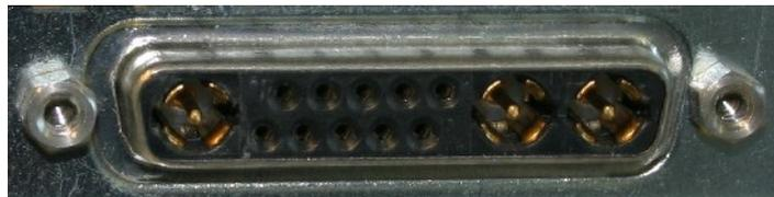
Diese analogen Videoschnittstellen werden zunehmend durch die digitale DVI-Videoschnittstelle ersetzt. (DVI = Digital Visual Interface). Viele neue Computer sind nur noch mit DVI-Video erhältlich.
