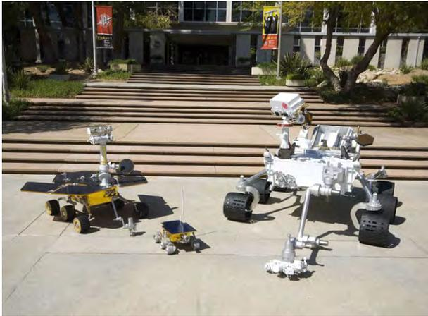
Abbildung 6.16: Vergleich der drei Marsrover Spirit (links), Sojourner (mitte) und Curiosity (rechts). NASA.
