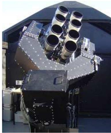
**Abbildung 7.6:** Die 8 Teleobjektive eines der beiden SuperWASP Observatorien. Auch mit relativ kleinen Teleskopen lässt sich heutzutage noch Forschung machen.
