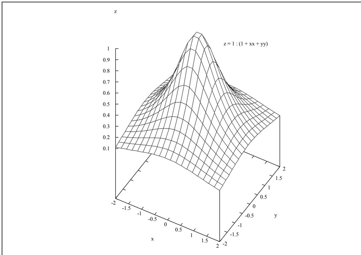
Funktionsfläche zu  $z = f(x,y) = \frac{1}{1+x^2+y^2}$  mit dem Zeichenprogramm gnuplot.
