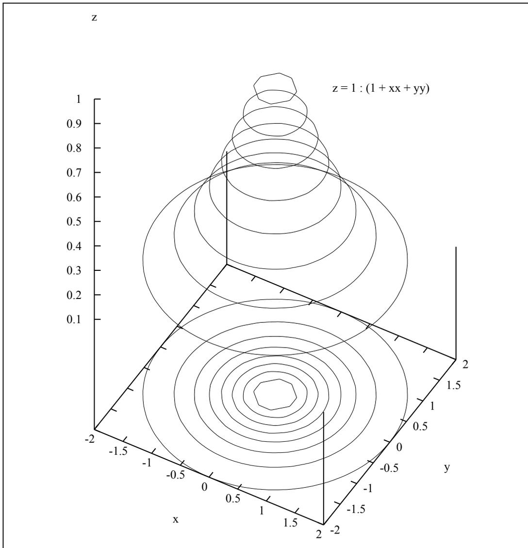
Eine weiteres Verfahren zeichnet die Linien auf der Funktionsfläche, die durch ebene Schnitte parallel zur Grundfläche entstehen. Die eine halbe Einheit über der Grundfläche verlaufende Ebene schneidet die Funktionsfläche in den Punkten mit den Koordinaten  $(x;y;0,5)$ .
