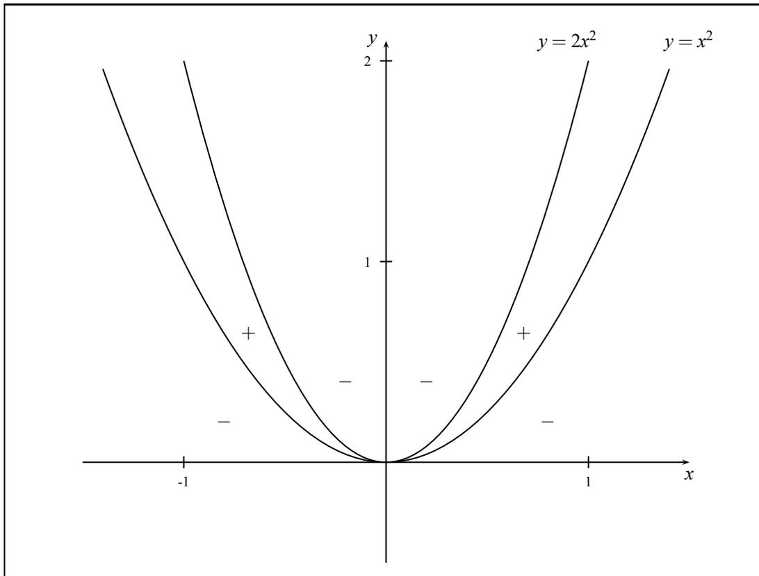
Die Funktion  $f(x,y) = (x^2 - y) \cdot (y - 2x^2)$  nimmt auf den Parabeln den Wert null an, zwischen ihnen ist sie positiv und sonst negativ. In der Umgebung des Nullpunktes nimmt sie positive wie negative Werte an, es liegt kein Extremum sondern ein Sattelpunkt vor.
