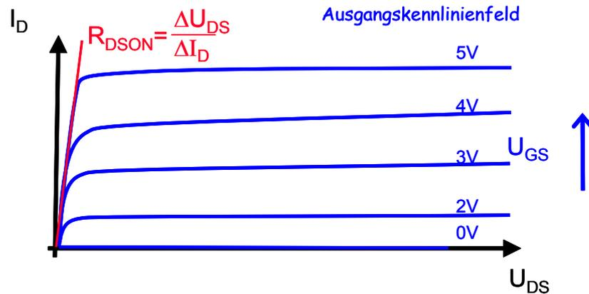
**Bild 75:** Ermittlung des Einschaltwiderstandes  $R_{\text{DSON}}$  eines selbstsperrenden n-Kanal MOSFETs
