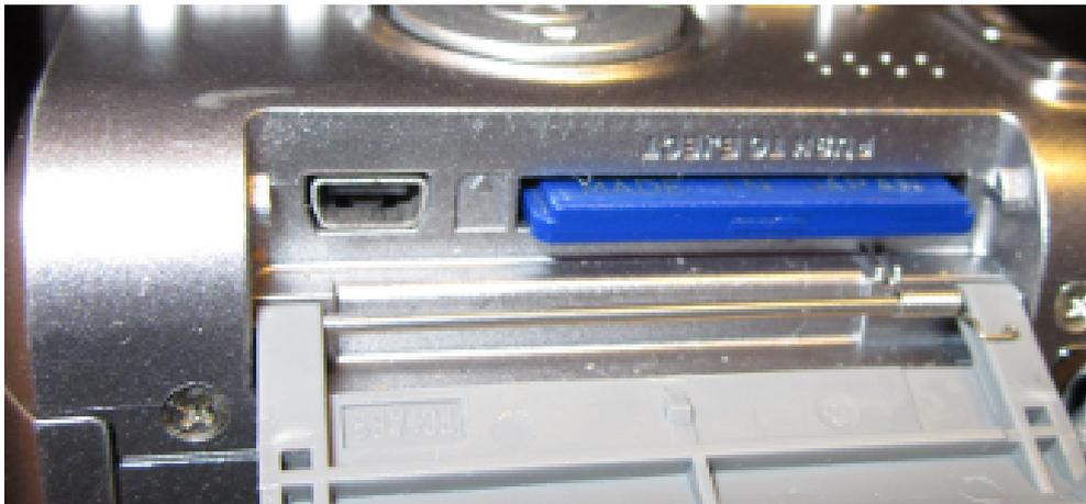
Abbildung 22: USB-Anschluss mit SD-Speicherkarte
