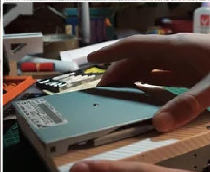
Die Platte für die Y-Achse wurde aus einer alten Diskettenabdeckung gefertigt. Benutzte etwas Sekundenkleber zusammen mit einer Schraube, um es an den Schienen zu befestigen.
