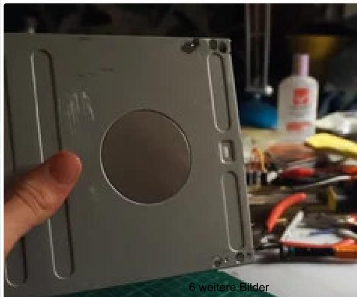
Die Y-Achse wird in einem alten DVD-Treibergehäuse untergebracht.
