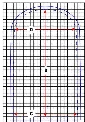
**2.** Das Musterteil für das Endteil nach den Abmessungen auf das Musterpapier aufzeichnen = gestrichelte blaue Linie. Eine Markierung oben in der Mitte einzeichnen. Um das Musterteil rundum 1 cm Nahtzugabe aufzeichnen = die blaue Linie.
