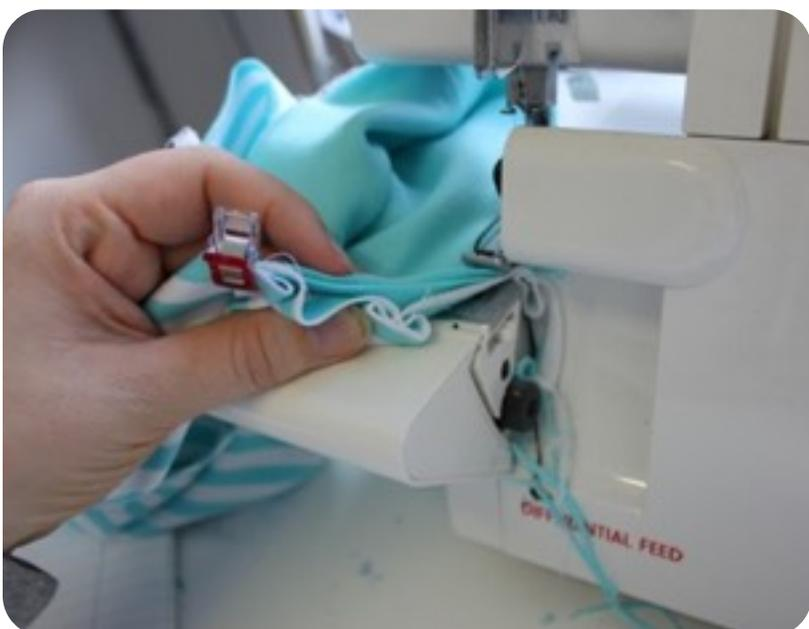
Nähe das Bündchen an die Hose an. Achte bei den Falten noch einmal darauf, dass sie flach liegen und du sie mit der Naht komplett erfasst.
